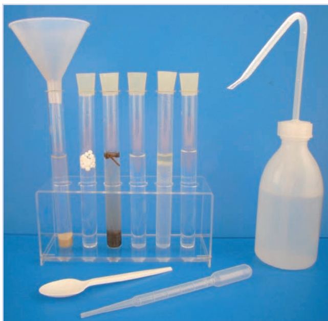
Abb. 1 Foto zum Experiment »Was löst sich in Wasser?«. Zu sehen sind Reagenzgläser in einem Ständer, zum Teil mit Stopfen verschlossen, ein Trichter, ein Teelöffel, eine Pipette und eine Spritzflasche mit Wasser. In den Reagenzgläsern befindet sich Wasser und von links nach rechts Sand, Styroporkügelchen, Gartenerde, Salz, Öl und Essig.
