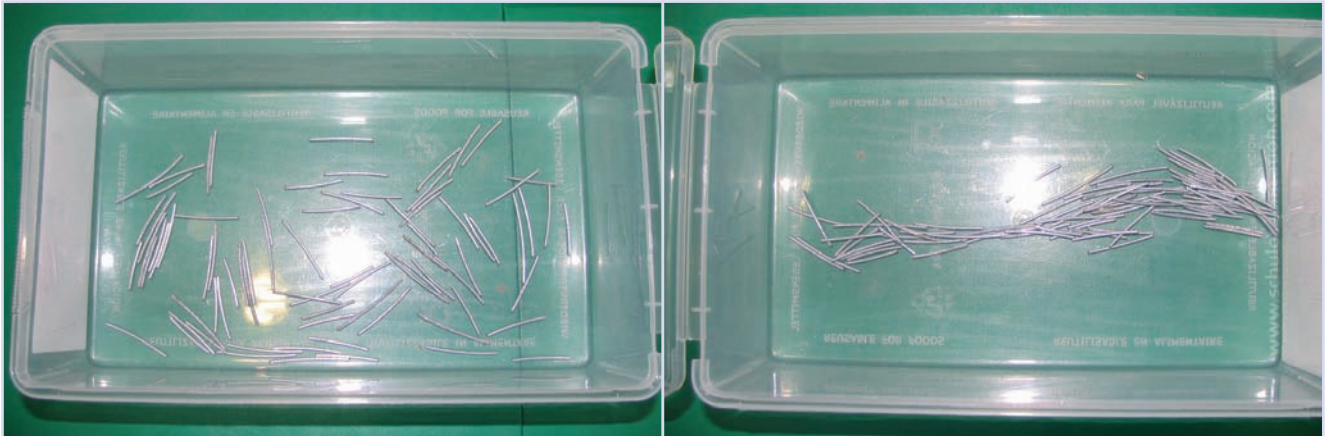
Abb. 4 Modell des unmagnetischen Drahtes (links) und des magnetischen Drahtes (rechts).
